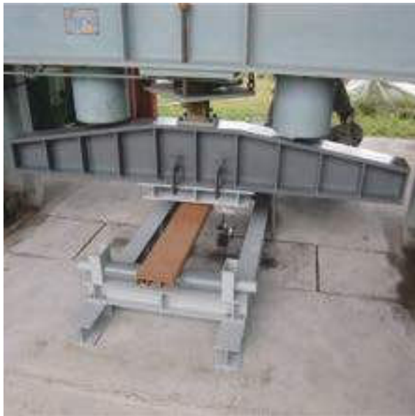
引抜材の破壊試験
