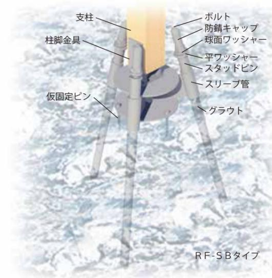
ロックファウンデーションでは、鉛直荷重はスタッドピン、水平剪断力・引抜荷重についてはロックボルトで受け持つ構造となっています。
